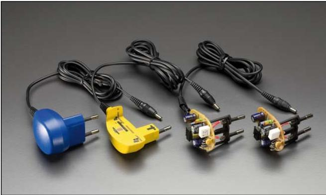
Bild 1: Elektronikverguss und Gehäusefertigung in einem Prozessschritt zusammengefasst.
