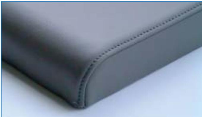
▲ **Abb. 2:** Bei dem neuen Verfahren ist ein Abdichten der Nähte überflüssig
